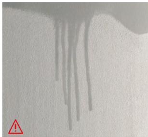
L'eau est absorbée rapidement, comme par un buvard. Pénétration excessive de la colle / Manque de glisse / Mauvais collage.
