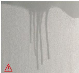
El agua se absorbe rápidamente, como si se tratara de una almohadilla absorbente. Se produce una penetración excesiva de cola, falta de lisura y mala adherencia.
