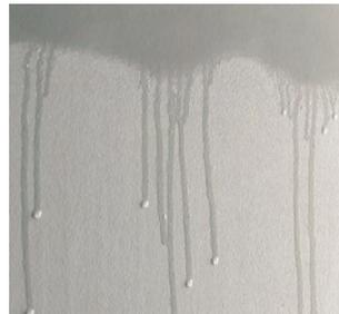
Das Wasser läuft an der Wand herunter und hinterlässt eine Feuchtigkeitsspur; es wird in weniger als zwei Minuten absorbiert.
