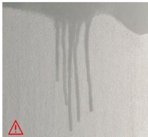
Das Wasser wird schnell aufgesogen, wie von einem Löschpapier. Übermäßiges Eindringen des Klebers / Fehlende Gleitfähigkeit / Schlechte Verklebung
